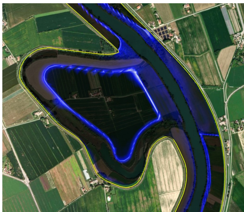
Figura 98. Evento di piena con portata di picco a Latisana di 3600 \text{ m}^3/\text{s} nelle condizioni d'alveo previste dal PGRA 2021, con il picco di piena in foce in fase con il picco di marea in assenza di scogliera in foce: contour dei massimi tiranti d'acqua raggiunti in corrispondenza dell'insediamento dell'Isola Picchi.
