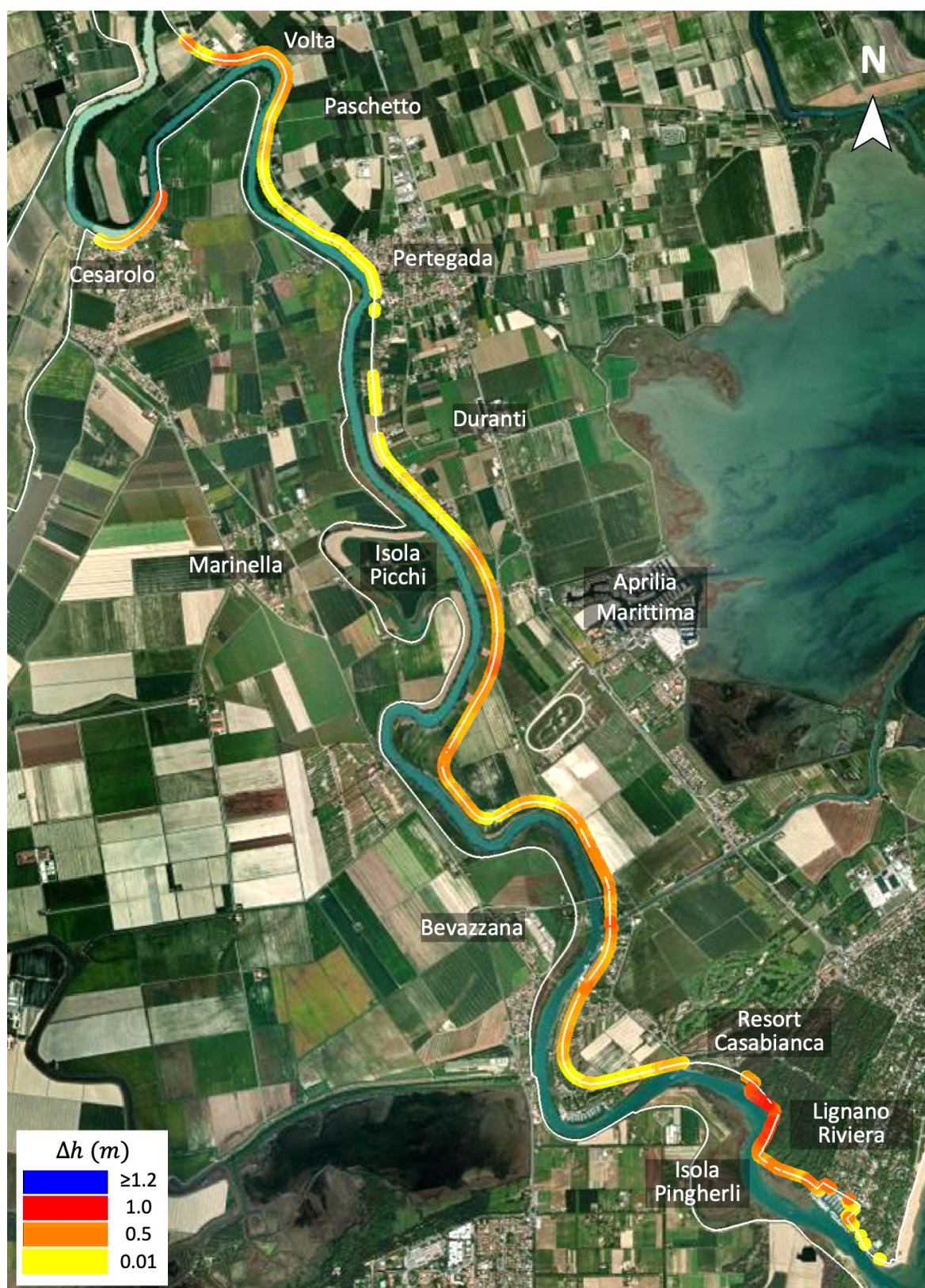
Figura 106. Differenza di quota \Delta h = \text{livello d'acqua massimo raggiunto in alveo} - \text{quota arginale} lungo la sponda sinistra del fiume Tagliamento dal nodo del Cavour fino alla foce. N.B. Sia in destra fiume che a Nord del nodo del Cavour non è stata fatta alcuna analisi, eccezionalmente si è riportato il \Delta h in corrispondenza della località di Cesarolo.
