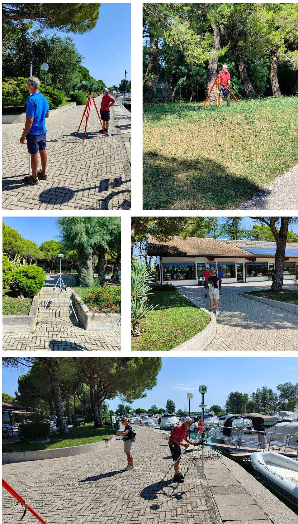
Figura 25. Immagini relative al rilievo da terra delle quote degli argini secondari, in sinistra Tagliamento, nel tratto compreso tra Marina Azzurra e Marina Punta Verde (30 luglio 2024).
