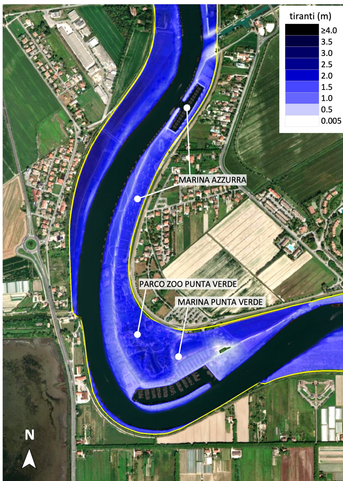
Figura 67. Evento di piena con portata di picco a Latisana di 4000 \text{ m}^3/\text{s} nelle condizioni d'alveo previste dal PAI 1997, con il picco di piena in foce in fase con il picco di marea: contour dei massimi tiranti d'acqua raggiunti in corrispondenza di Marina Azzurra, lo Zoo e Marina Punta Verde.
