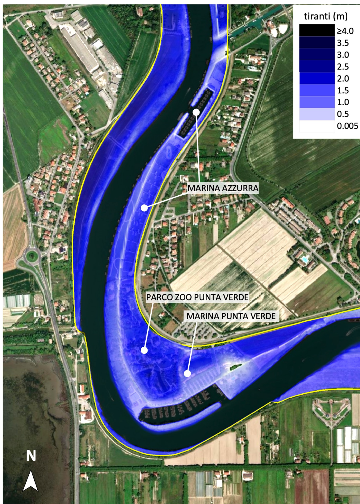
Figura 80. Evento di piena con portata di picco a Latisana di 4000 \text{ m}^3/\text{s} nelle condizioni d'alveo previste dal PAI 1997, con il picco di piena in foce in opposizione di fase con il picco di marea: contour dei massimi tiranti d'acqua raggiunti in corrispondenza di Marina Azzurra, lo Zoo e Marina Punta Verde.
