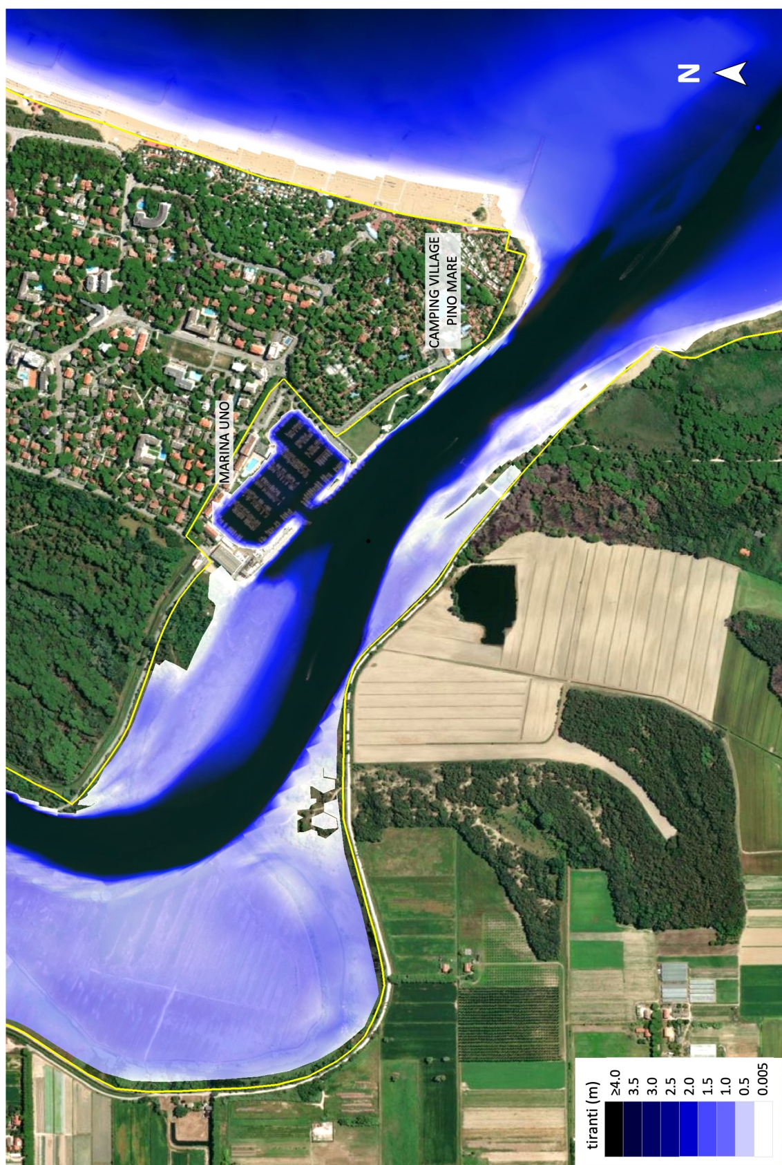
Figura 42. Evento di piena Vaia: contour dei massimi tiranti d'acqua raggiunti in corrispondenza di Marina Uno e del Camping Village Pino Mare. La linea gialla indica il contorno della mesh.
