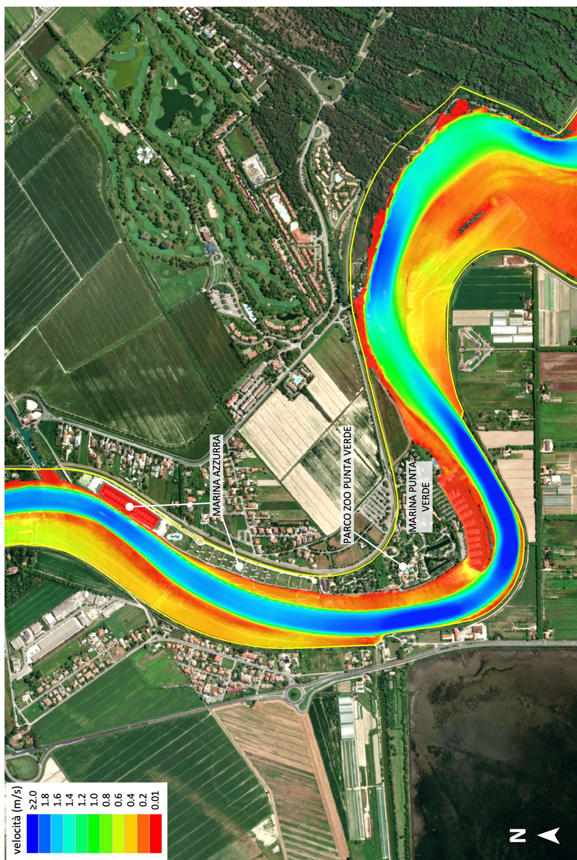
Figura 43. Evento di piena Vaia: contour delle velocità massime raggiunte in corrispondenza di Marina Azzurra, lo Zoo e Marina Punta Verde. La linea gialla indica il contorno della mesh.
